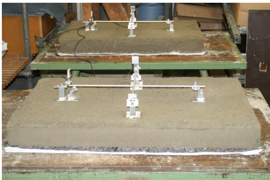
Bild 3: Schwindversuche an Spritzbeton; Frühschwinden + Trocknungsschwinden
